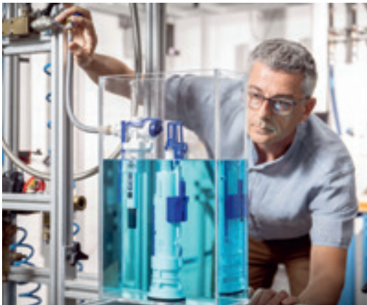
↑ HYDRAULIIKAN ASIAANTUNTEMUS Geberitin saniteettitekniikan laboratorioissa huuhtelu- ja täyttövventtiilit testataan, jotta ne voivat osoittaa maksimaalisen hydraulisen suorituskyvyn ja läpäistä pitkäaikaiset kestävyystestit.
