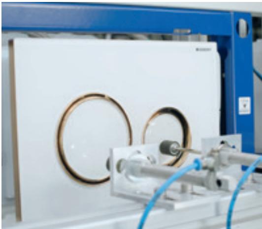
↑ KUORMITUSTESTI Geberitin keraamisten tuotteiden on läpäistävä tiukat kuormitustestit ja täytettävä luotettavasti kaikki asiaankuuluvat standardit.
