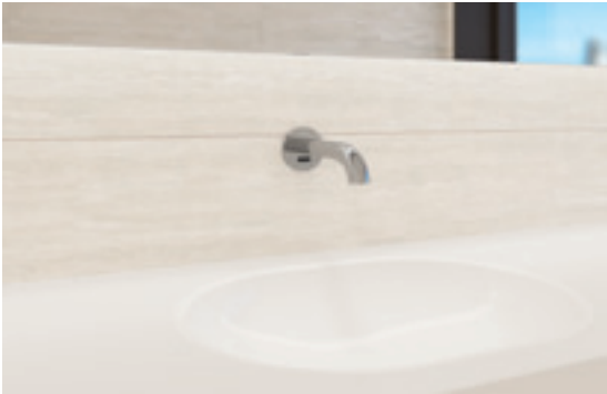
1 PESUALLASHANAT Geberit-pesuallashanojen Piave, Brenta, tyyppi 185 ja tyyppi 186 (seinä- tai allashanat) avulla voidaan suorittaa intervallihuuhtelu 1–168 tunnin välein ja enimmillään 200 sekunnin ajan. Geberit-pesuallashanat ovat saatavana verkkoon liitettävinä tai paristokäyttöisinä muutostöitä varten.
