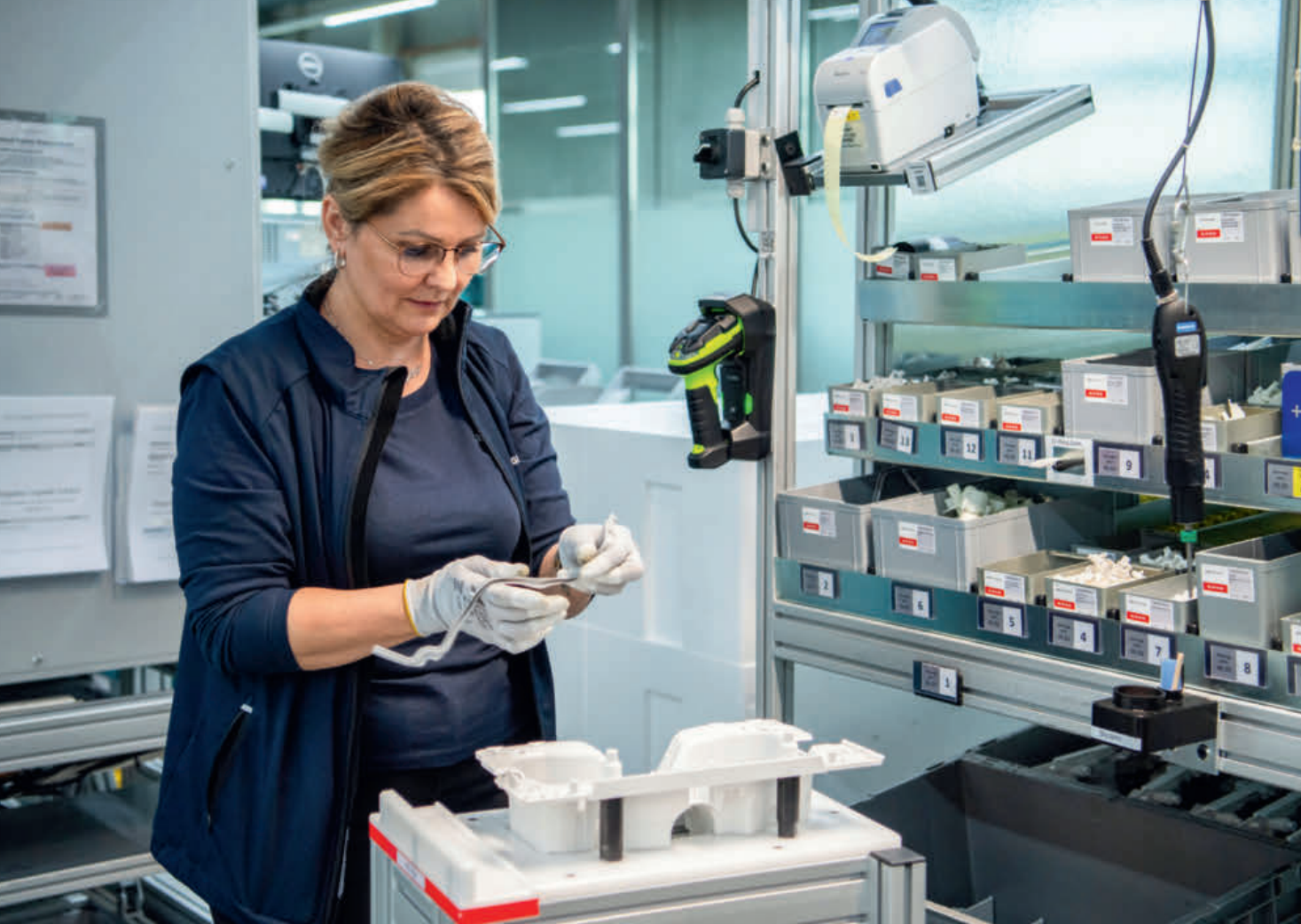
↑ Matka alkaa tyhjästä kotelosta – Jasminka Rodojković asettaa tiivisteen.
